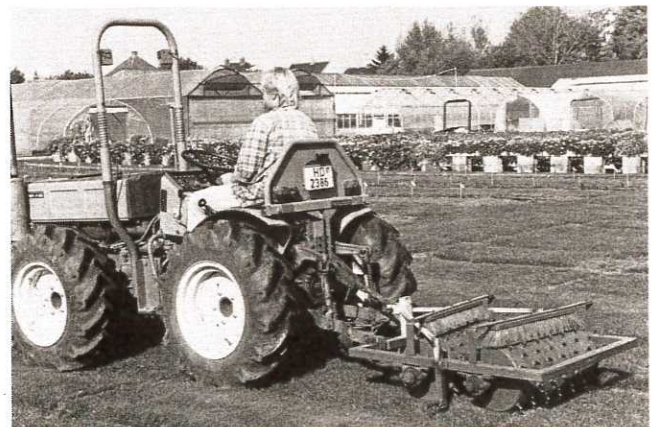
Stollenwalze mit 2 ca. 15° schräg zueinander stehenden Walzen. Pro Walze 100 Stollen = 15 kp/cm 2 Druck. Bei 8 Walzgängen pro Woche entspricht dieses in etwa 3—4 Std. Spielbetrieb pro Tag.
